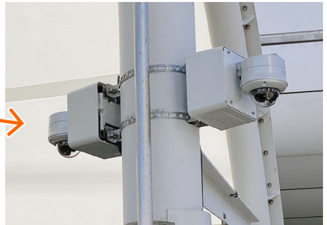
駅前などに設置されているタウンレコーダー。 機器異常発生時は自動メールで通知があるため、現場での定期的なメンテナンスが不要。
