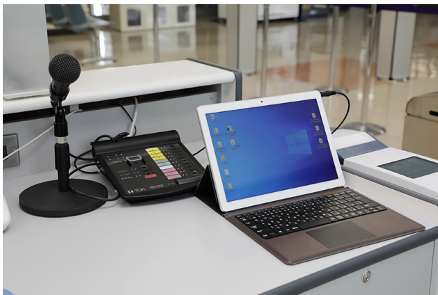
ホールディングルーム（搭乗待合室）のカウンターにある卓上型リモートマイク。個別エリアやグループ、一斉放送を選択して放送。タブレットなど、外部入力による放送もできる。
