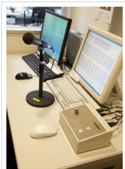
アナウンス卓 放送回線の選択はタッチパネル画面で行え、高い操作性を有しています。また、メッセージ放送音源の録音、放送スケジュールの構築から実施まで、一貫して行うことができます。
