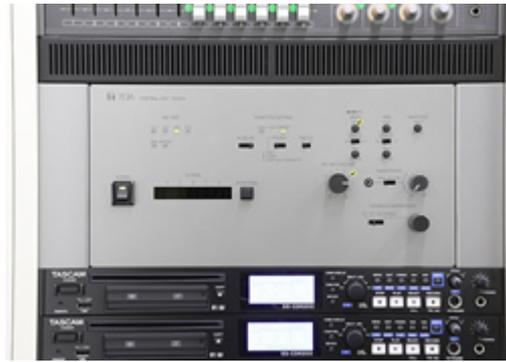
中央には有線赤外線統合会議システム センター装置TS-910、同架内には議場内の音響調整を行うデジタルミキサーD-2000シリーズも収納されている。
