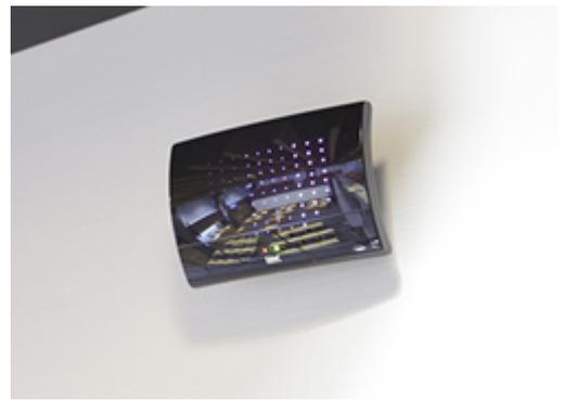
難聴者補助システムとして傍聴席に設置された赤外線レーザー。
