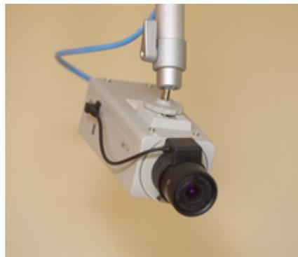
屋内に設置されているネットワークメガピクセルカメラN-CC2100M、レンズは近赤外メガピクセル対応レンズCT-MR3VFG。
