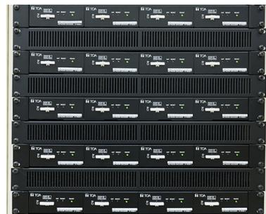
設計制約が多い中で、既設の同軸ケーブルを利用し、かつAI機能や拡張性をもつTRIFORAシステムへ更新を可能にしたビデオエンコーダー N-V5020-1。
