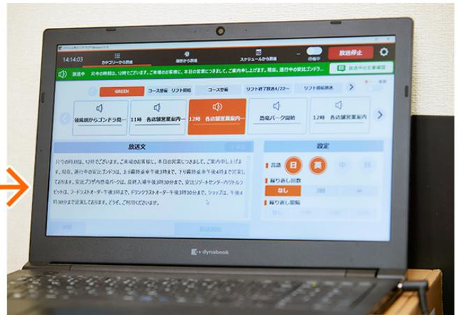
「アナウンスクリエーター」のソフトウェアの 카테고리から放送文を選択して、日本語/英語のアナウンス音源の再生を行える。スケジュール機能により、自動放送の設定も可能。(アナウンス音源は各自のPCで事前に作成し、USBにてソフトに入れている)
