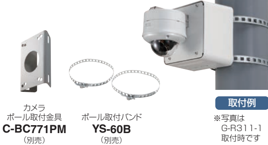
※ポールから300mmまたは400mm離して設置できます。 カメラ アタッチメント金具 SCAT-T2 (幹旋品、別売) 槍出金具用アーム(*) LAC-30 (イワフチ株式会社製) 自在バンド(*) 3BD-HD-23 (ポール径: 230~320mm) 3BD-HD-30 (ポール径: 300~410mm) (イワフチ株式会社製) ※写真は G-R311-1 取付時です
