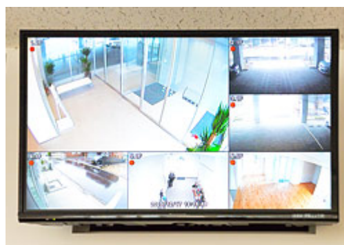
1階エントランスに設置されているドーム型HD-SDIカメラH-C1210-3、 来客用の呼び出しパネルと連動し、各階に設置された訪問先の社内モニターに来客者の映像を鮮明に映し出します。
