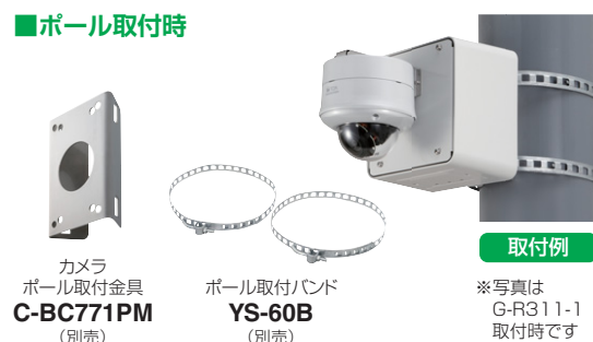
※ポールから300mmまたは 400mm離して設置できます。 カメラ アタッチメント金具 SCAT-T2 (回転品、別売) 槍出金具用 アーム(*) LAC-30 (イワブチ株式会社製) 自在バンド(*) 3BD-HD-23 (ポール径: 230 ~ 320mm) 3BD-HD-30 (ポール径: 300 ~ 410mm) (イワブチ株式会社製) ※写真は G-R311-1 取付時です
