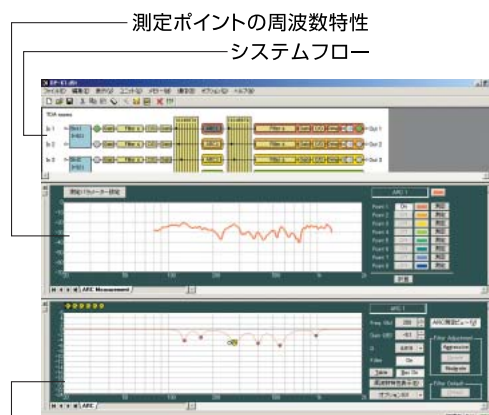
ARCフィルター <ARC操作画面>
