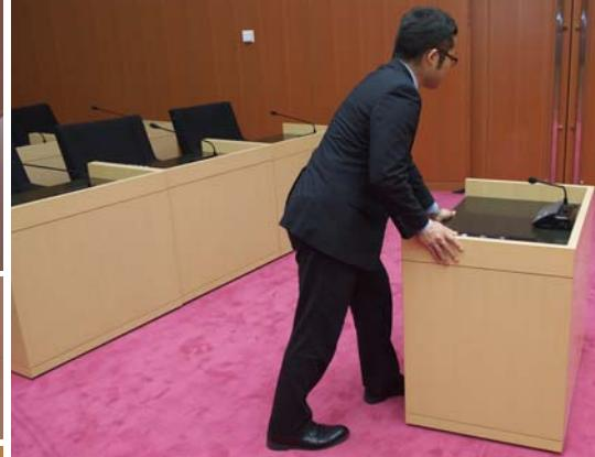
議席が可動式のため、コードレスで設置できる赤外線マイクユニットを採用。レイアウト変更や多目的利用の際の席の移動が容易。
