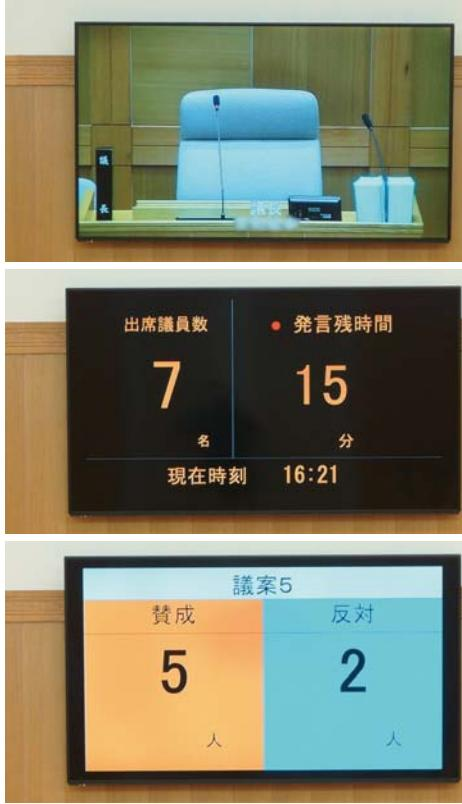
本会議場の側面に設置されている70型の大型モニター。マイクと連動して映し出される発言者の映像や、出席議員者数と発言残時間、電子採決の結果などをソフトウェアのボタンひとつで切り替えて表示できる。
