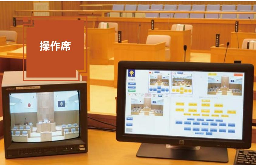
操作席のタッチパネルモニター。会議システム、カメラシステム、発言残時間システム、テロップ、電子採決システムの制御が行える。また、議会だよりに掲載する写真もスナップショット機能で、操作席から撮影できる。
