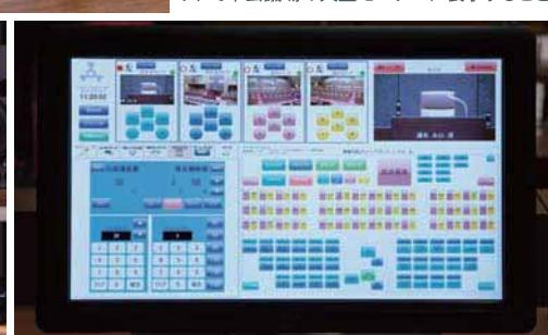
操作席のタッチパネルモニター。定例会の際は主にモニター室での操作になるが、ここでも会議システム、カメラシステム、発言残時間システム、テロップ、電子採決システムの制御が可能。
