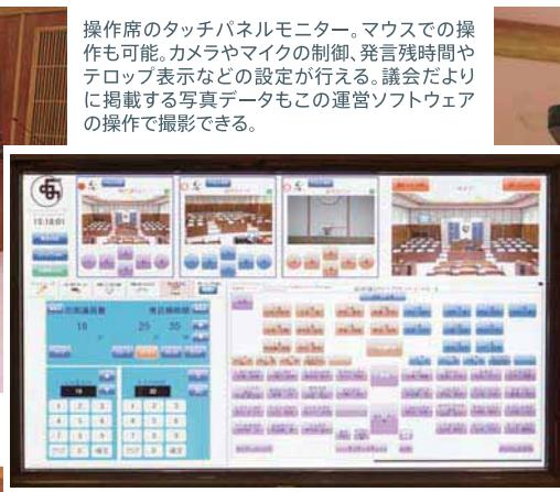
操作席のタッチパネルモニター。マウスでの操作も可能。カメラやマイクの制御、発言残時間やテロップ表示などの設定が行える。議会だよりに掲載する写真データもこの運営ソフトウェアの操作で撮影できる。
