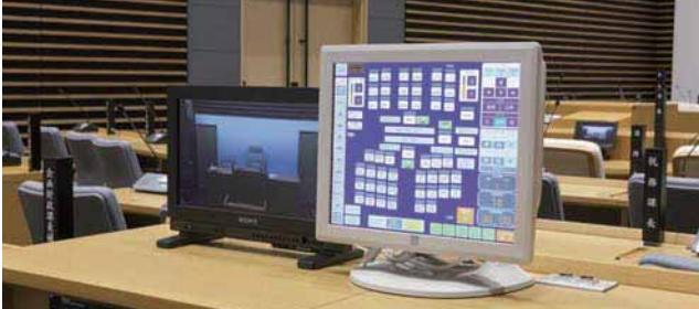
操作席のタッチパネル。マイクやカメラの制御、出席議員数や発言残時間の設定、モニター表示の切り替え、採決、テロップの挿入等を行うことができる。
