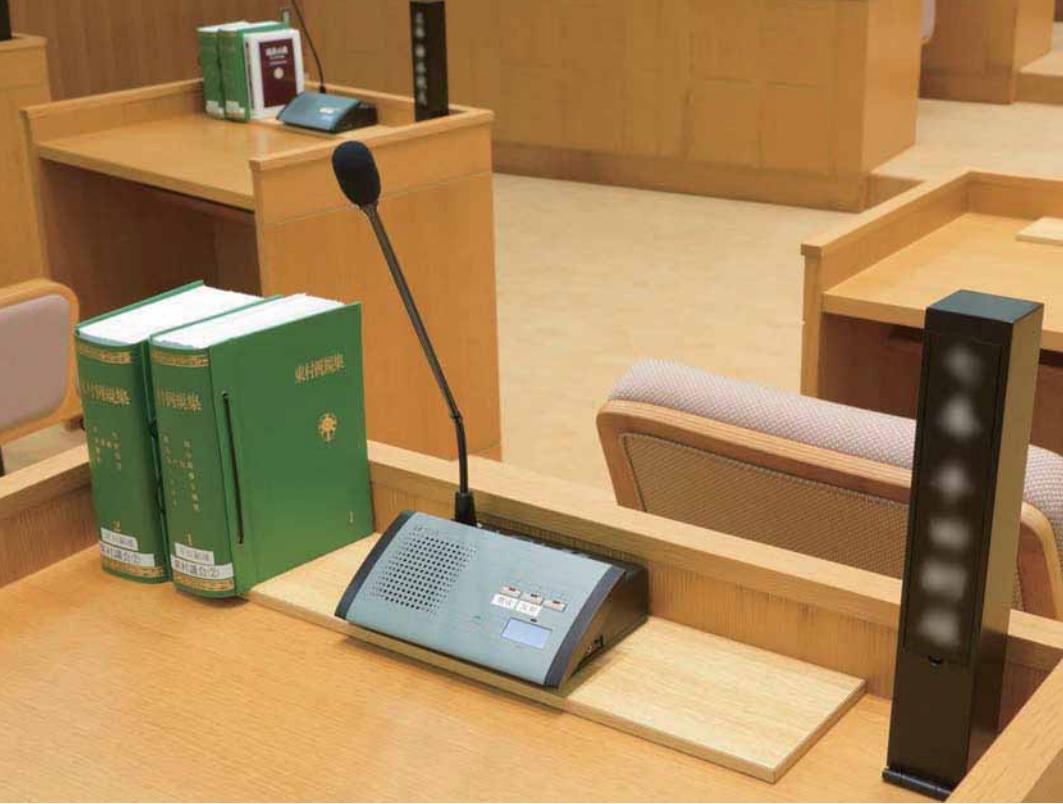
議員席用の参加者ユニット TS-912。電子採決が採用されており、「賛成」・「反対」ボタンを押すと、採決結果が本会議場の大型モニターや議長席の7型モニター、操作席のタッチパネルモニターに表示される。
